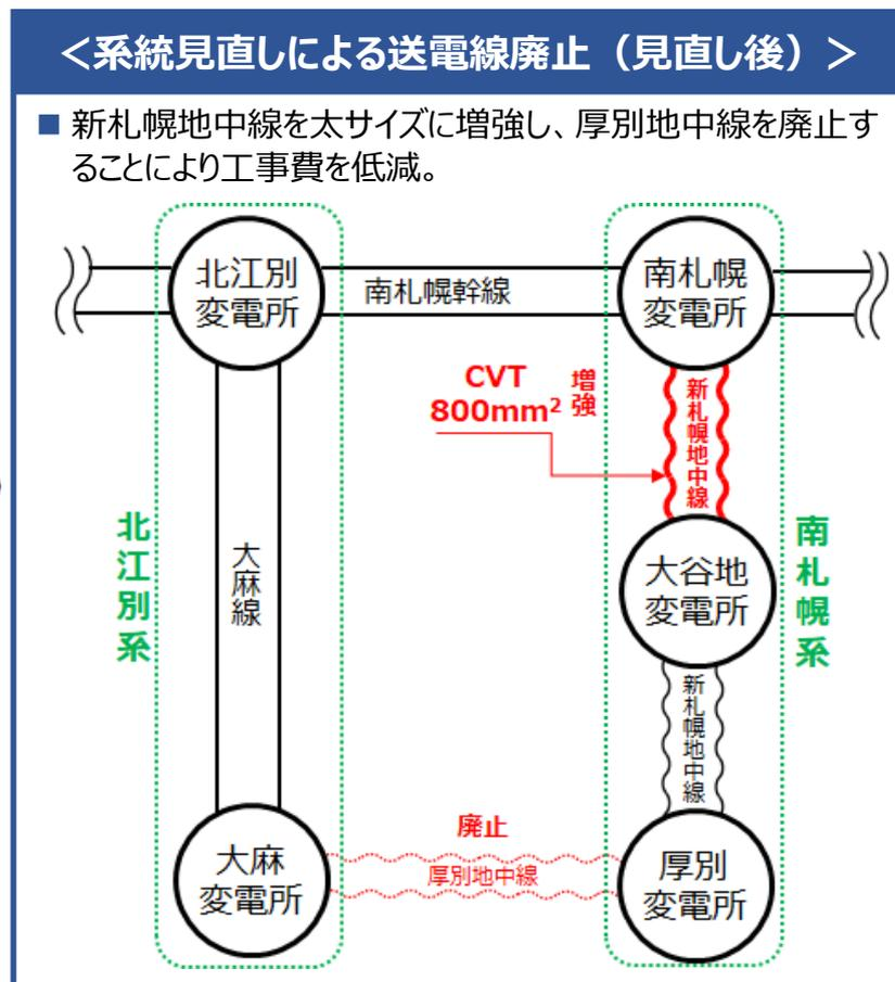
(具体例) 系統構成の見直しによる送電線廃止
