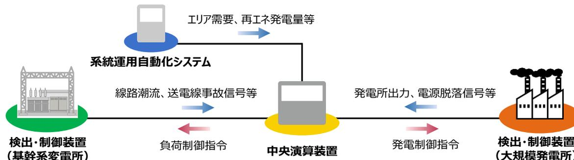
■ 再エネの連系拡大に伴いインバータ電源（非同期電源）が増加する一方、火力発電所等の同期電源が減少することにより基幹系統の電圧調整能力が低下し、適正電圧の維持が課題となっています。
