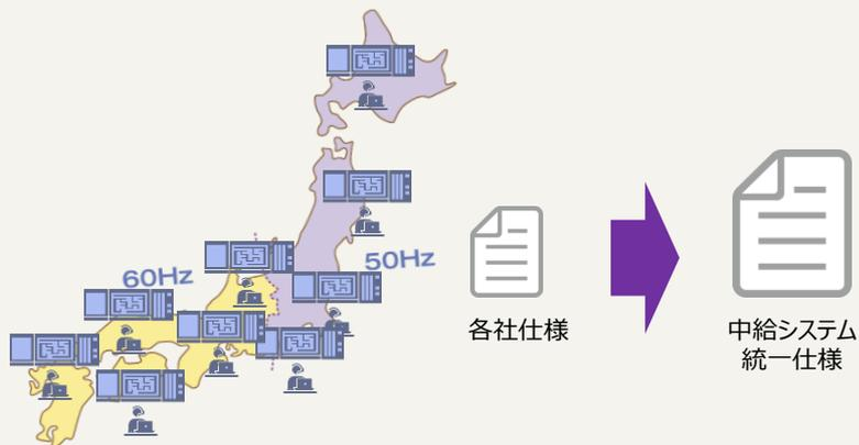
※LFC：電力需給バランスをとるため、系統周波数や連系線潮流の変化を検出して、発電機出力を調整する機能
