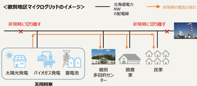
自然災害等による大規模停電時に、当社の送配電ネットワークから切り離し、エリア内のバイオガス発電設備・太陽光発電設備などによって、地域の皆さまへ電力供給することを目指す。
