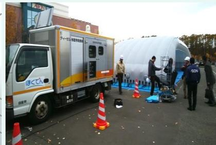
移動発電機車による電力供給
