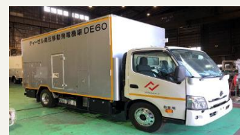
高圧移動発電機車
