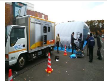
発電機車による電力供給
