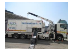
可搬型大容量海水送水ポンプ車
