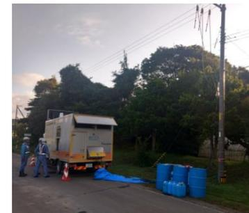
移動発電機車による応急送電
