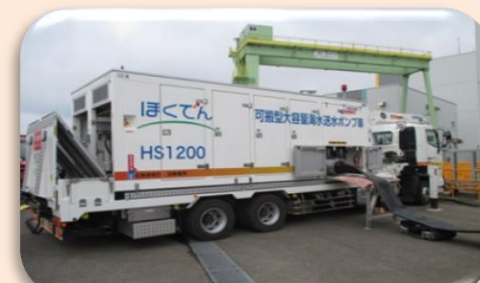
可搬型大容量海水送水ポンプ車の設置訓練
