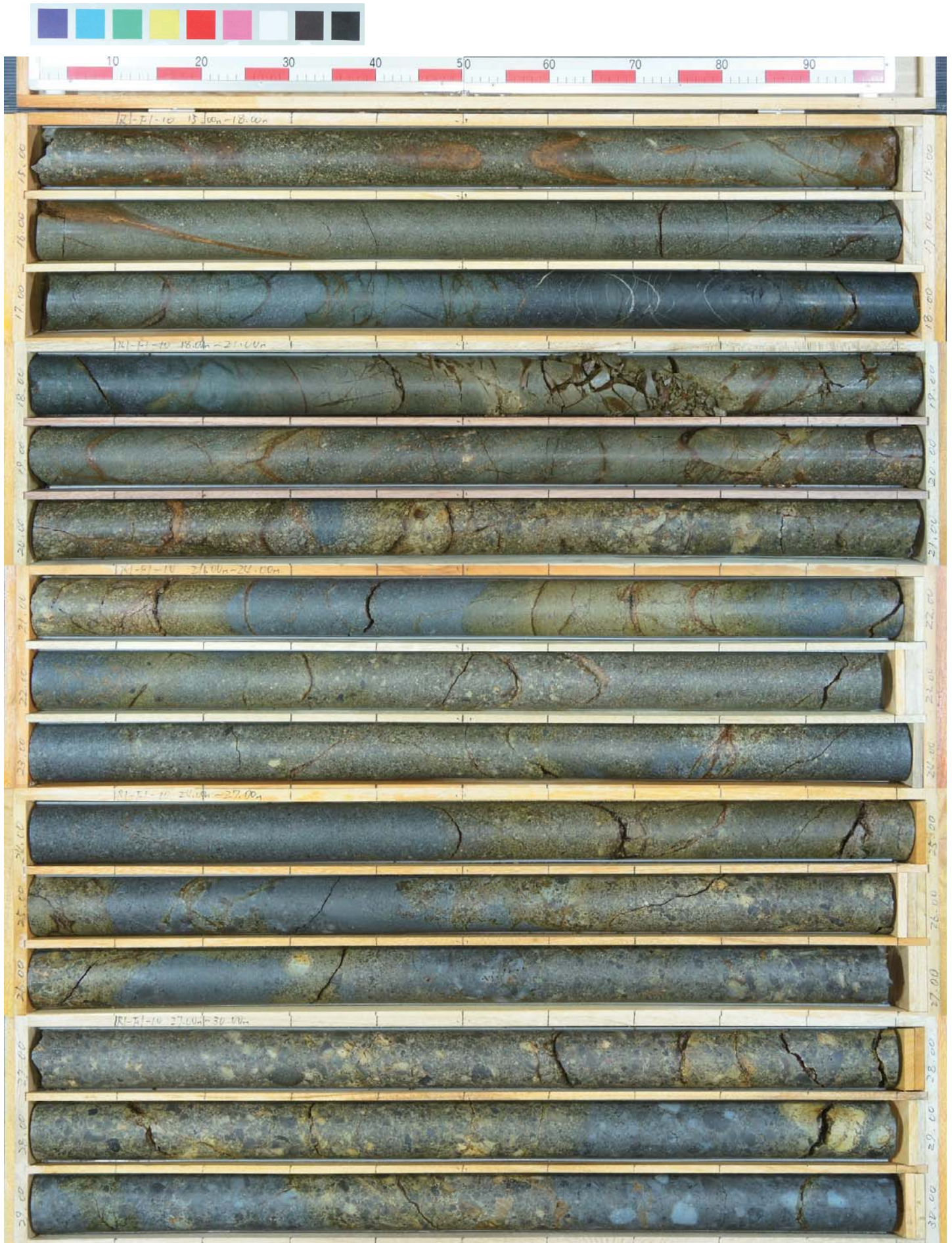
コア写真(確認-2ボーリング:深度15~30m)
