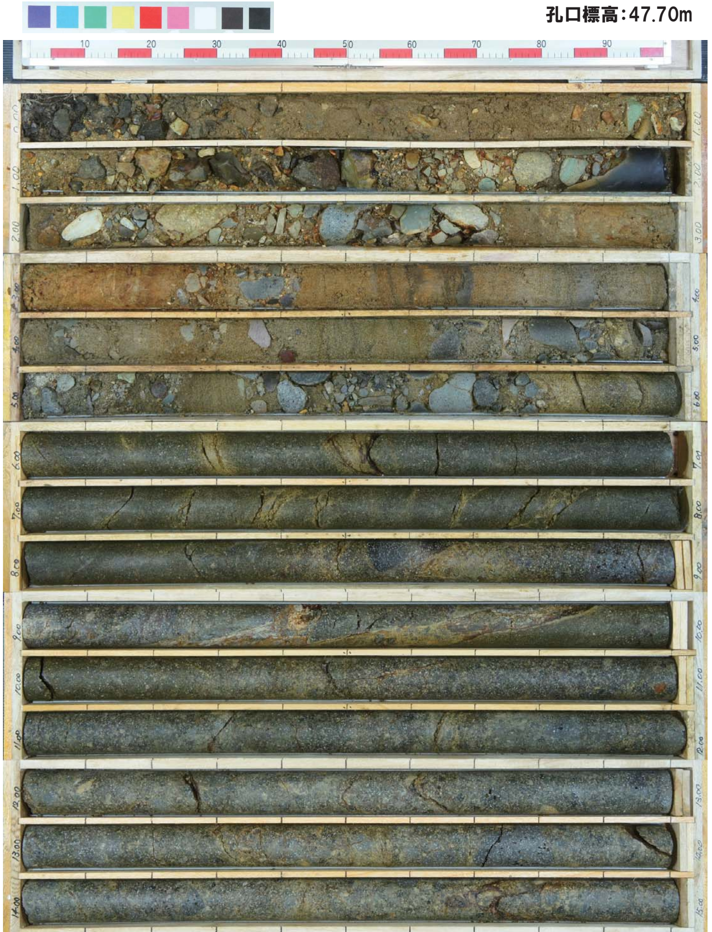
コア写真(確認-3ボーリング:深度0~15m)
