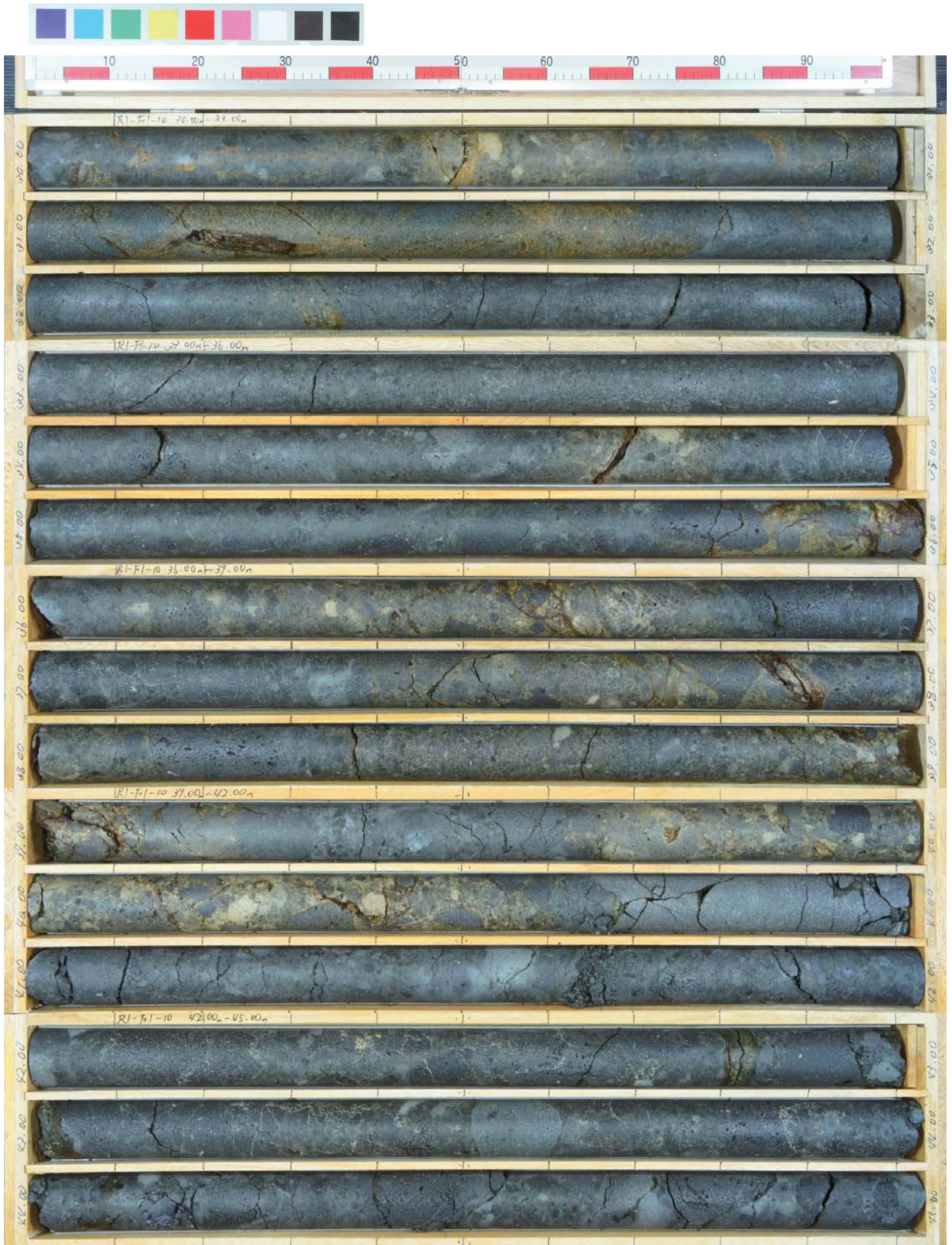
コア写真(確認-2ボーリング:深度30~45m)
