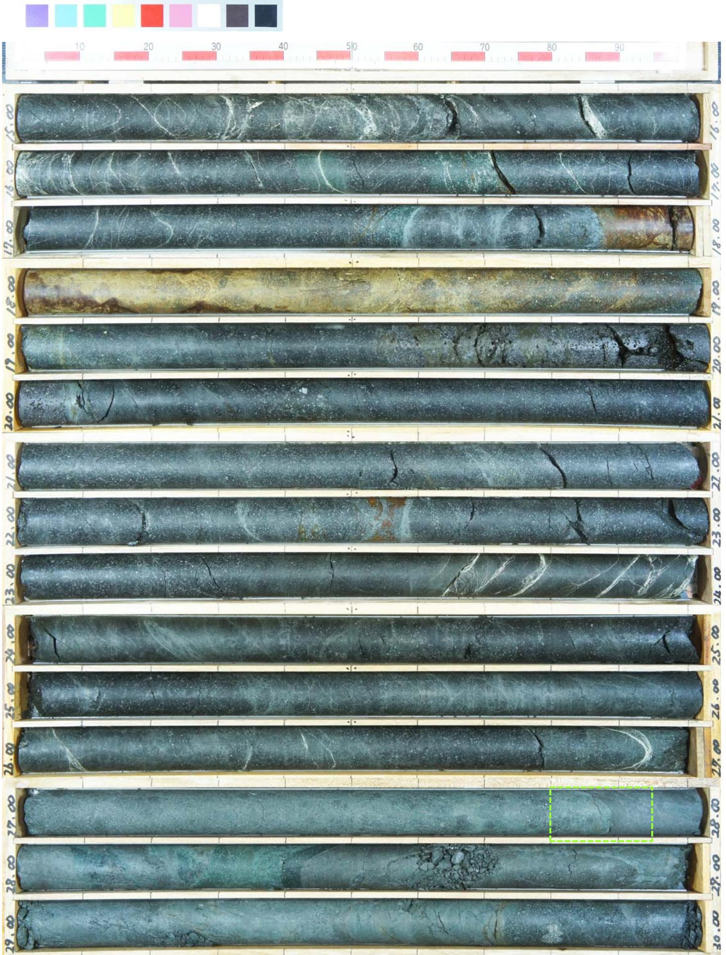
※劣化部の定義は、「未固結な粘土を挟在若しくは付着する割れ目及びその周辺に分布する節理、裂かを伴う帯」。
