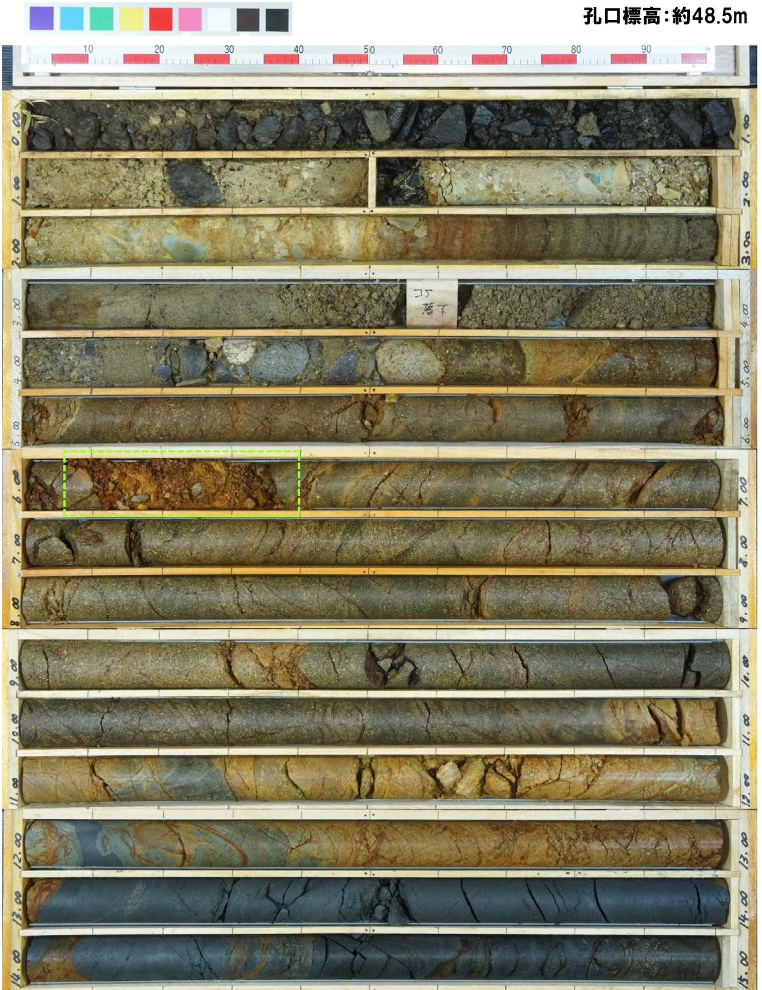
※劣化部の定義は、「未固結な粘土を挟む若しくは付着する割れ目及びその周辺に分布する節理、裂かを伴う帯」。
