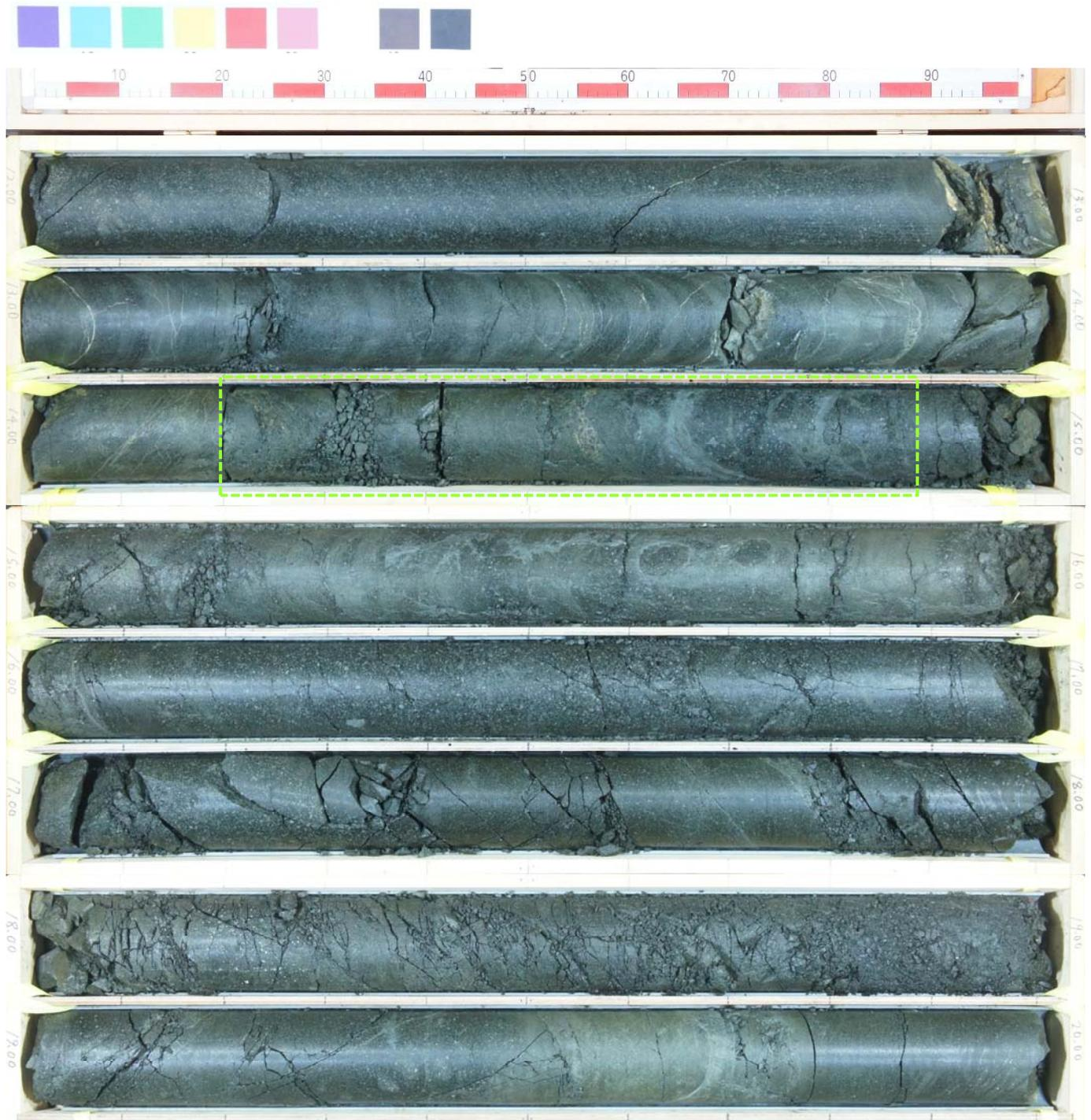
※劣化部の定義は、「未固結な粘土を挟在若しくは付着する割れ目及びその周辺に分布する節理、裂かを伴う帯」。
