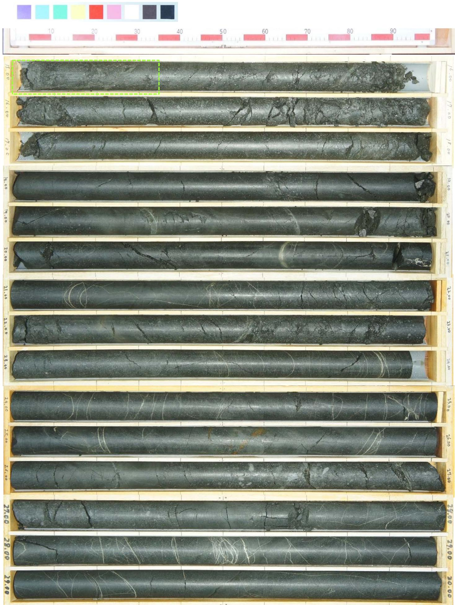
※劣化部の定義は、「未固結な粘土を挟む若しくは付着する割れ目及びその周辺に分布する節理、裂かを伴う帯」。
