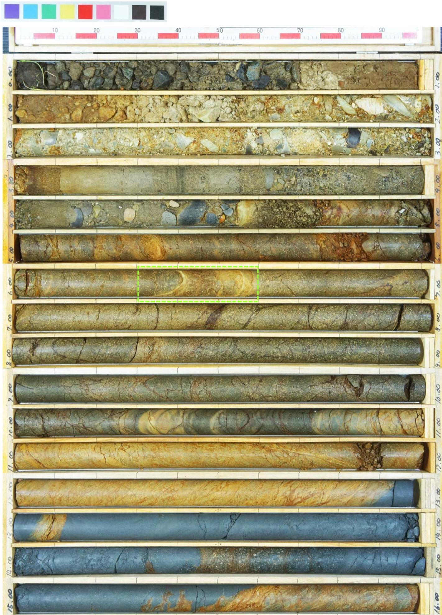
※劣化部の定義は、「未固結な粘土を挟む若しくは付着する割れ目及びその周辺に分布する節理、裂かを伴う帯」。本資料においては、劣化部のうち、F-1断層の走向傾斜と類似、かつ推定深度付近に出現するものを図示。
