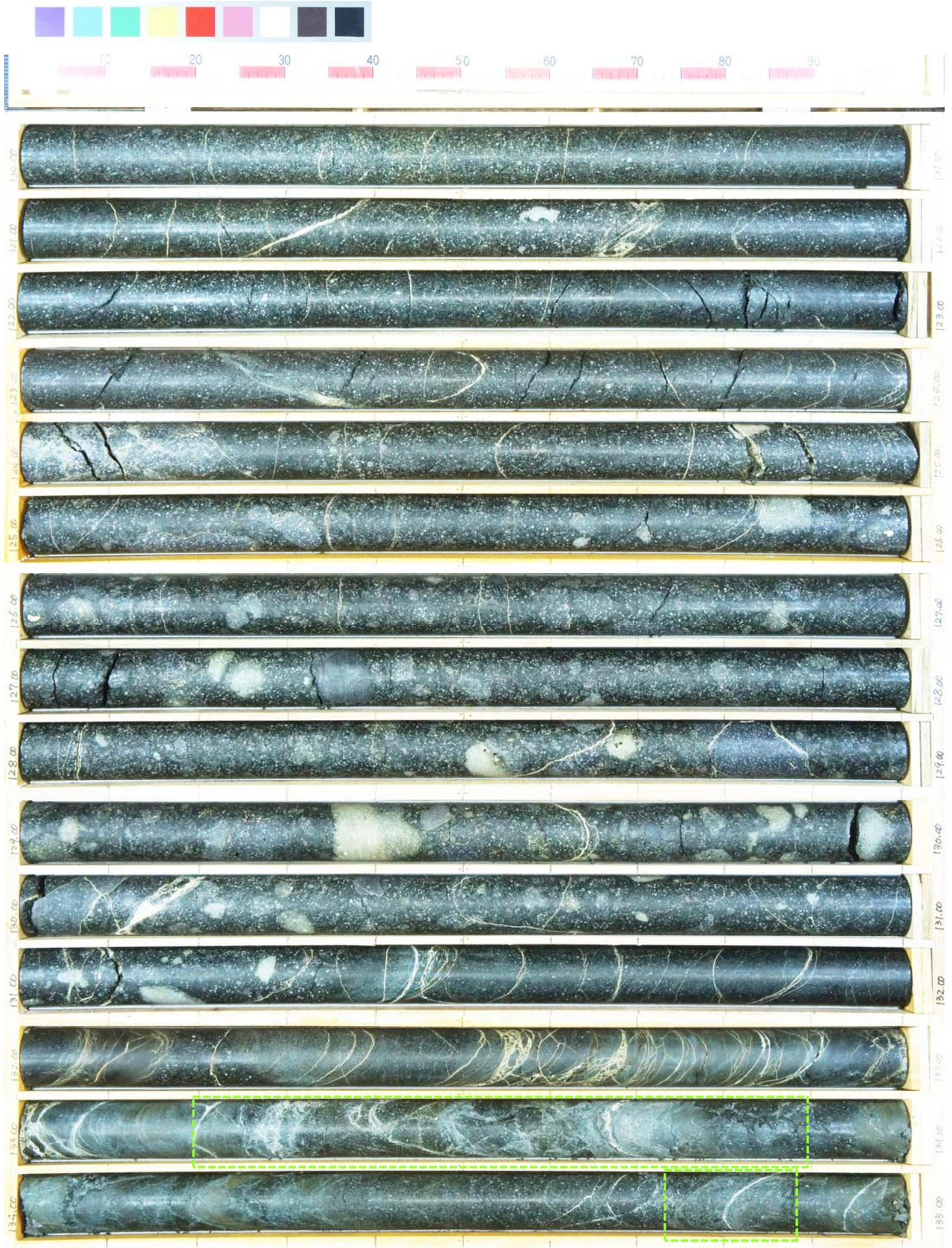
※劣化部の定義は、「未固結な粘土を挟在若しくは付着する割れ目及びその周辺に分布する節理、裂かを伴う帯」。本資料においては、劣化部のうち、F-1断層の走向傾斜と類似し、かつ推定深度付近に出現するものを図示。
