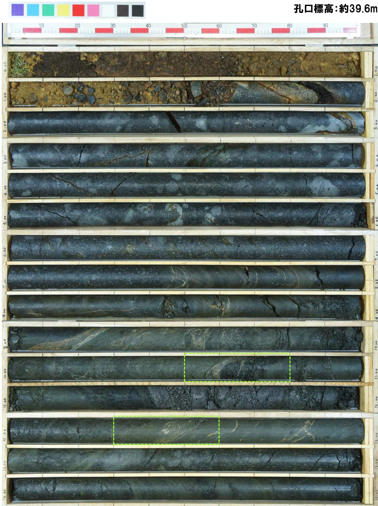
※劣化部の定義は、「未固結な粘土を挟む若しくは付着する割れ目及びその周辺に分布する節理、裂かを伴う帯」。本資料においては、劣化部のうち、F-1断層の走向傾斜と類似し、かつ推定深度付近に出現するものを図示。
