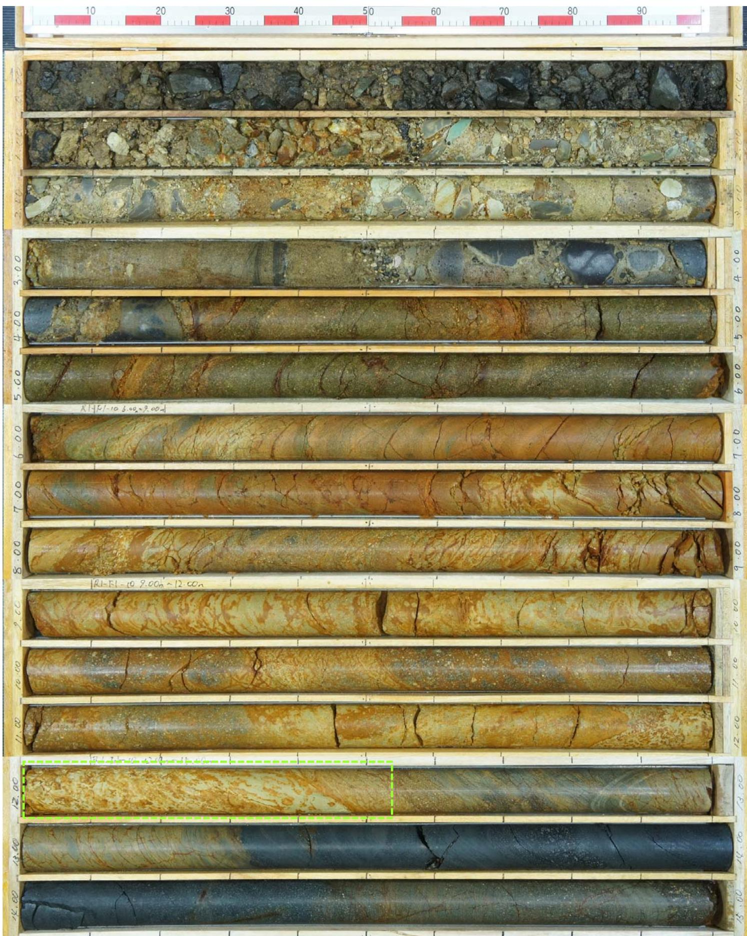
※劣化部の定義は、「未固結な粘土を挟む若しくは付着する割れ目及びその周辺に分布する節理、裂かを伴う帯」。本資料においては、劣化部のうち、F-1断層の走向傾斜と類似し、かつ推定深度付近に出現するものを図示。
