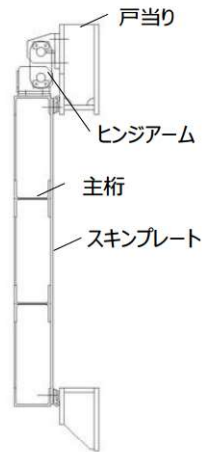
3号機原子炉補機冷却海水放水路逆流防止設備
