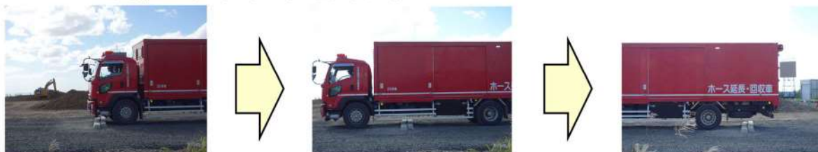
第2図 段差15cmの走行性能検証
