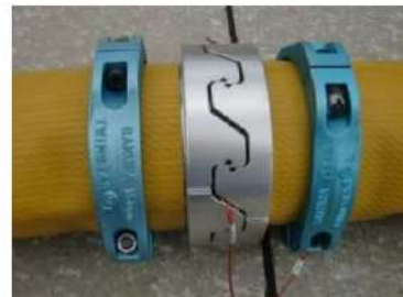
可搬型ホース（150A）接続後
