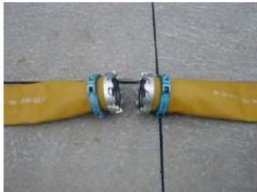
可搬型ホース(150A)接続前
