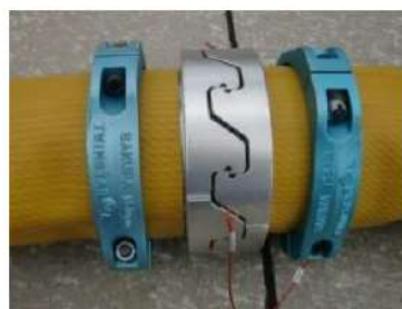
可搬型ホース(150A)接続後
