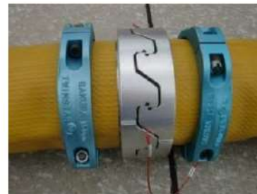
可搬型ホース(150A)接続後
