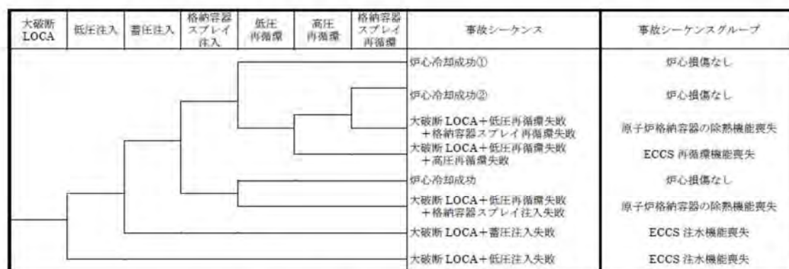
第 3.1.1. d-1 (a) 図 大破断 LOCA イベントツリー
