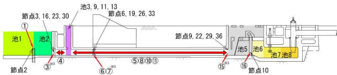
図 13-1 1号及び2号炉取水施設の損失水頭発生位置 (上図：平面図，下図：断面図)
