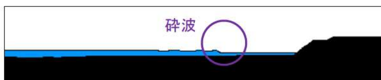
参考図 4-44 護岸直前の津波波形（基準津波 B（北防波堤損傷））
