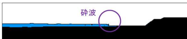
参考図 4-59 護岸直前の津波波形（基準津波 L（北防波堤損傷））
