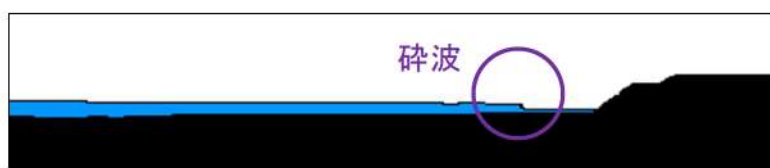
参考図 4-52 護岸直前の津波波形（基準津波 F（北及び南防波堤損傷））
