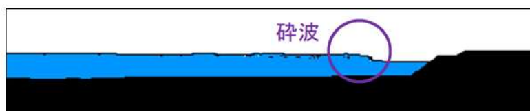
参考図 4-38 護岸直前の津波波形（基準津波 K（南防波堤損傷））
