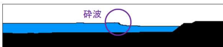
参考図 4-39 護岸直前の津波波形（基準津波 L（北防波堤損傷））
