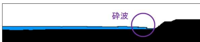
参考図 4-45 護岸直前の津波波形（基準津波 C（防波堤損傷なし））
