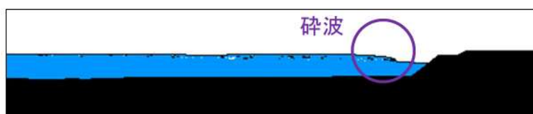
参考図 4-22 護岸直前の津波波形（基準津波 A（防波堤損傷なし））
