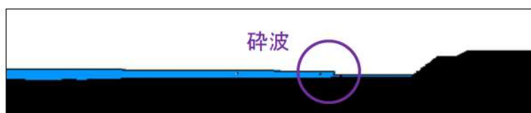
参考図 4-54 護岸直前の津波波形（基準津波 G（南防波堤損傷））
