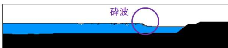
参考図 4-23 護岸直前の津波波形（基準津波 B（防波堤損傷なし））
