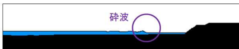
参考図 4-43 護岸直前の津波波形（基準津波 B（防波堤損傷なし））
