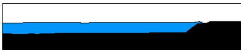
参考図 4-12 護岸直前の津波波形（基準津波 F（北及び南防波堤損傷））
