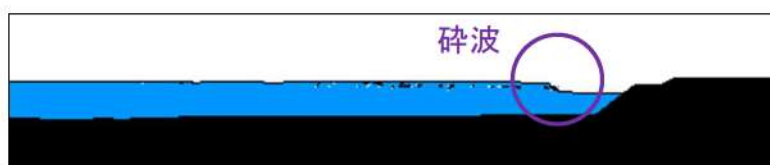
参考図 4-30 護岸直前の津波波形（基準津波 E（北及び南防波堤損傷））
