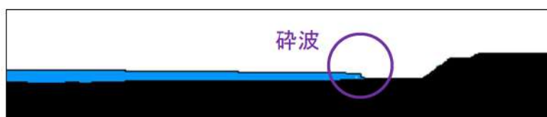
参考図 4-42 護岸直前の津波波形（基準津波 A（防波堤損傷なし））
