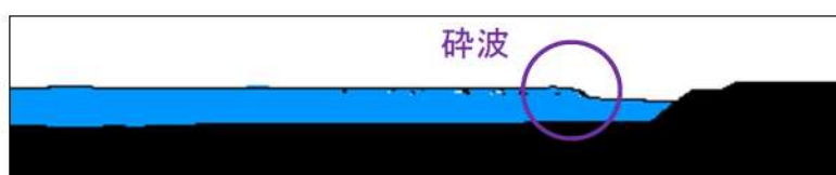
参考図 4-34 護岸直前の津波波形（基準津波 G（南防波堤損傷））
