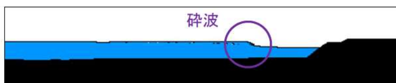
参考図 4-35 護岸直前の津波波形（基準津波 H（北防波堤損傷））
