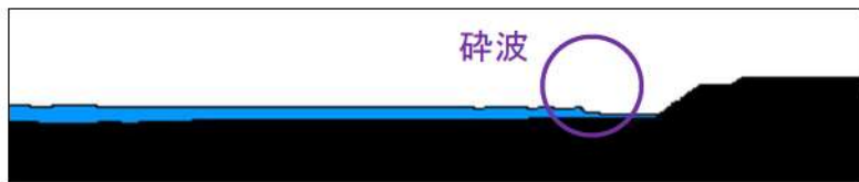
参考図 4-50 護岸直前の津波波形（基準津波 E（北及び南防波堤損傷））
