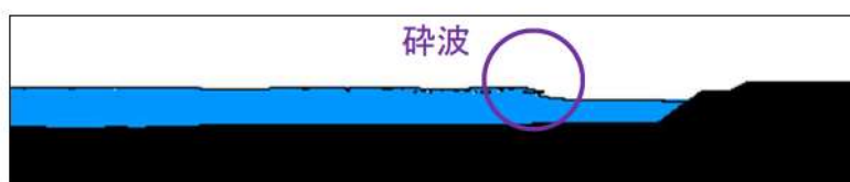
参考図 4-24 護岸直前の津波波形（基準津波 B（北防波堤損傷））
