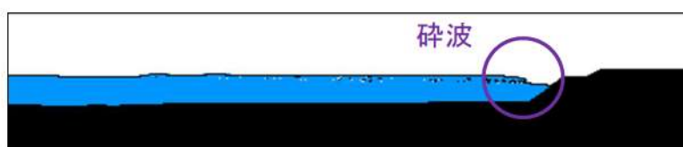
参考図 4-36 護岸直前の津波波形（基準津波 I（防波堤損傷なし））
