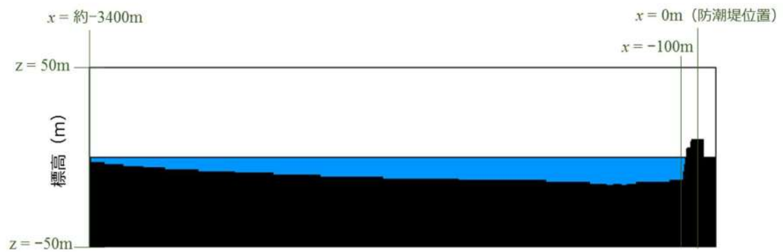
第 1 6 図 第 2 波評価断面の解析モデル
