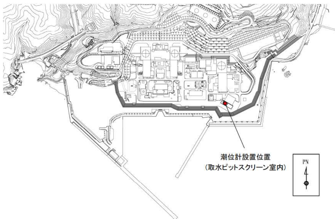
図4 泊発電所における潮位計設置位置
