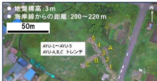
見市川の河口部で見市川の流路方向と直行する方向にトレンチ (AYU-1~AYU-5) の掘削を行い、低位段丘 (低位段丘状の地形) を構成する堆積物の観察を行ったとされている。
