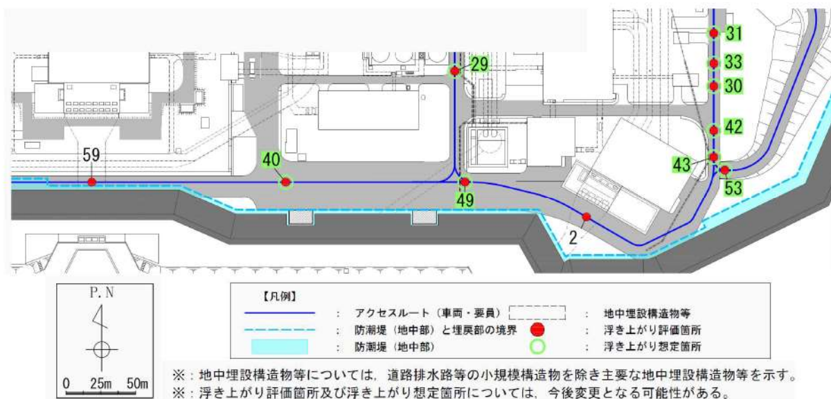
第 6-42 図 液状化による浮き上がりの評価結果（5/5）（D エリア）
