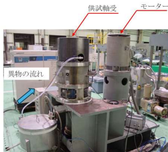
第2図 原子炉補機冷却海水ポンプ軸受摩耗試験装置
