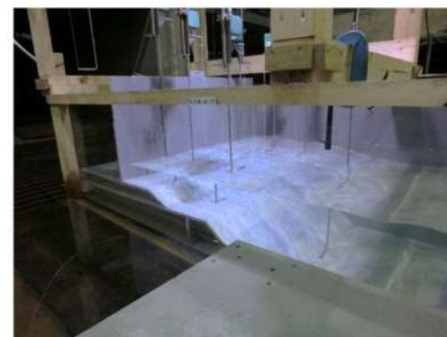
津波波圧計測状況
