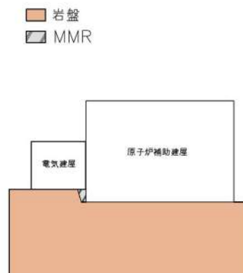
第3図 電気建屋の設置状況（断面②）
