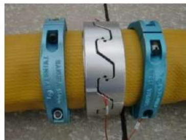
可搬型ホース(150A)接続後
