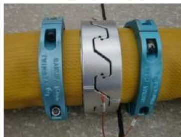
可搬型ホース(150A)接続後
