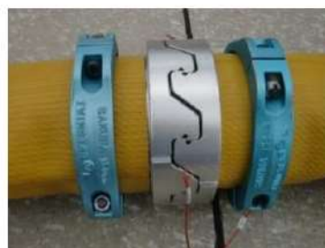
可搬型ホース (150 A) 接続後
