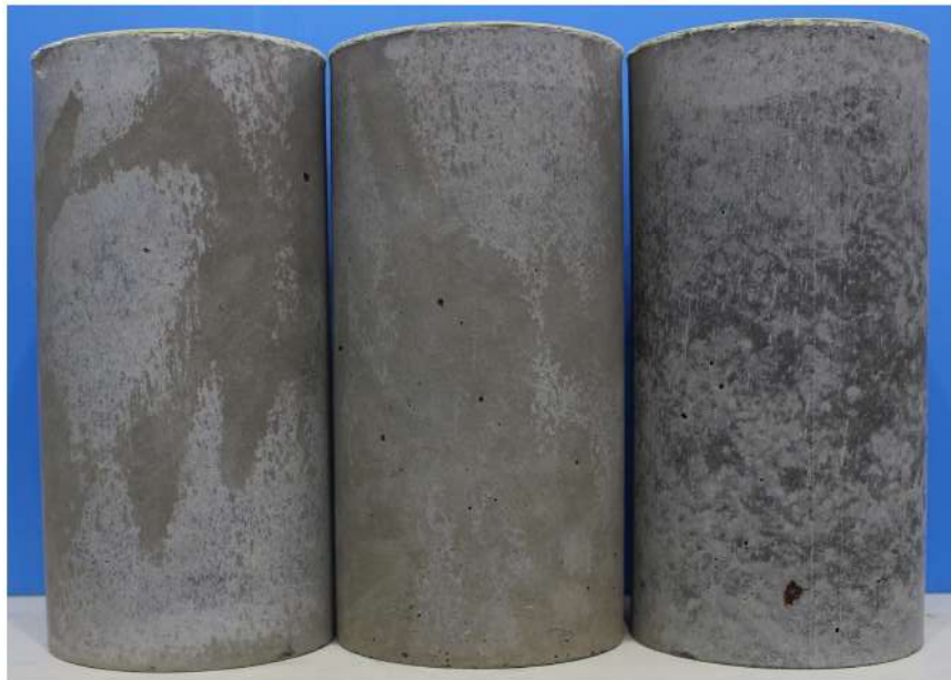
一軸圧縮試験用供試体（ \phi 150\text{mm} , H300mm）
