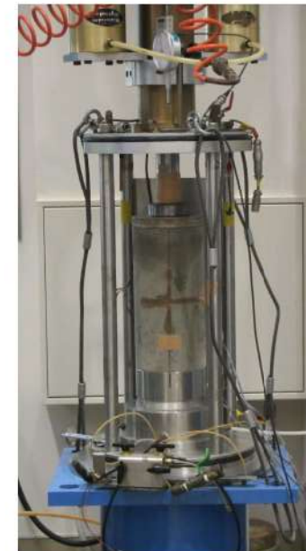
一軸圧縮試験の状況
