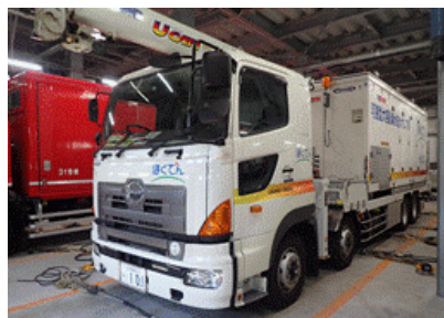
可搬型大容量海水送水ポンプ車
