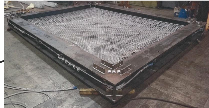
飛来物防護設備
