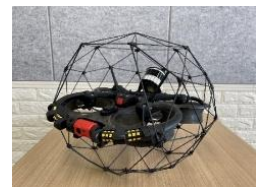
屋内点検用ドローン (ELIOS 3)
