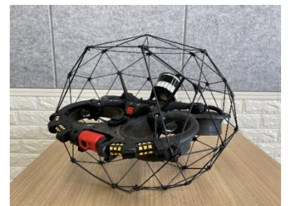
屋内点検用ドローン (ELIOS 3)
