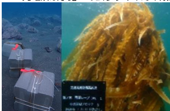
森町産のホタテの貝殻を使用した低炭素藻礁ブロック（左）と藻礁ブロックを用いて培養したマコンブ（右）
