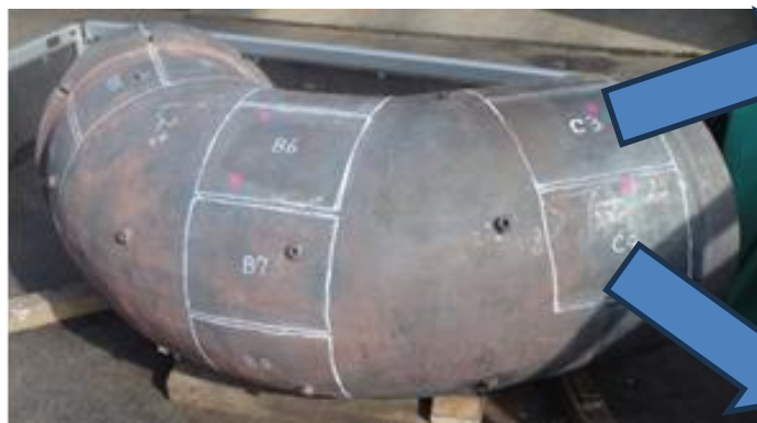
苫東4号再熱蒸気配管廃材
