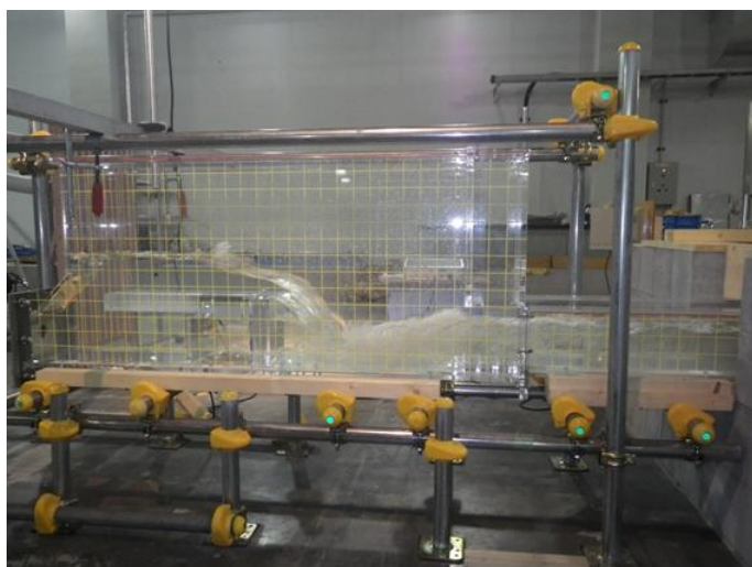
水力発電所の余水放流設備に関する水理模型実験
