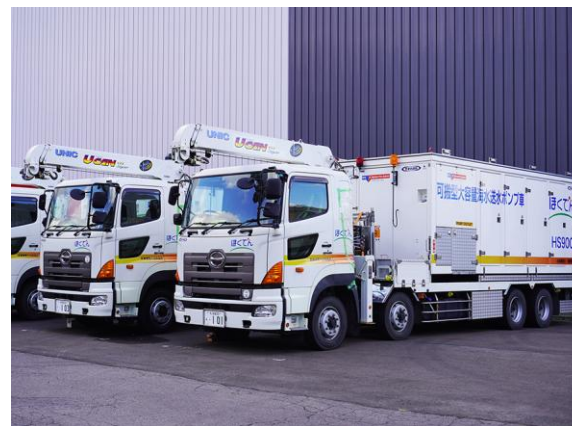
可搬型海水送水ポンプ車
