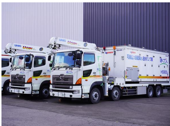
可搬型海水送水ポンプ車
