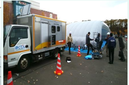
移動発電機車による電力供給
