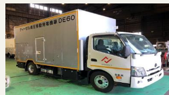
高圧移動発電機車
