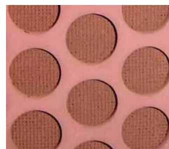
清掃前 （金網が目詰まりしている）
