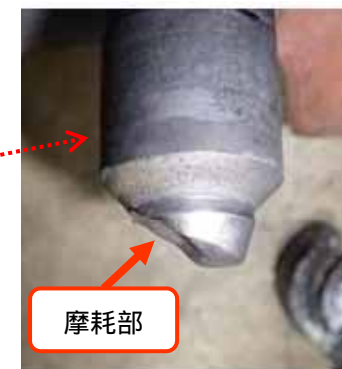
不具合状況 (弁内部部品摩耗)
