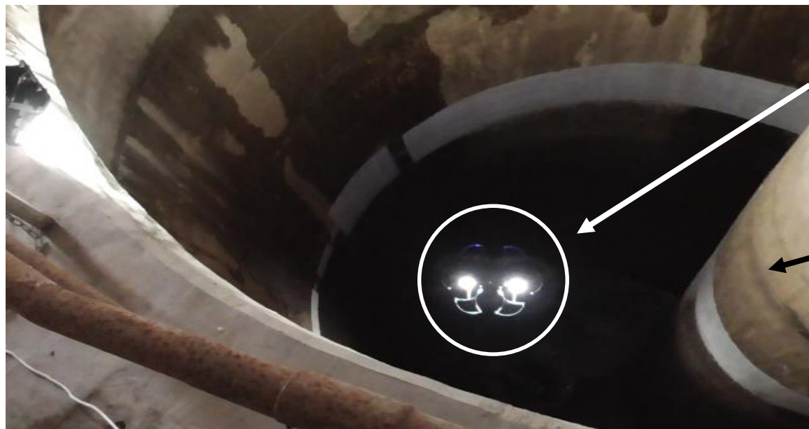
▲調圧水槽内を降下しながら壁面を撮影するドローン
