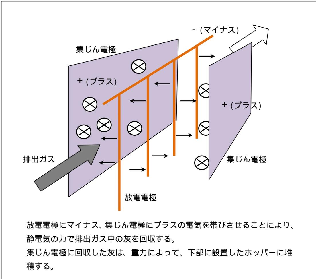
放電電極にマイナス、集じん電極にプラスの電気を帯びさせることにより、静電気の力で排出ガス中の灰を回収する。
