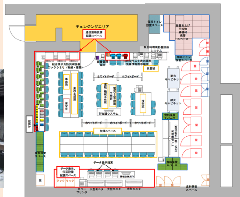
緊急時対策所 指揮所配置例
