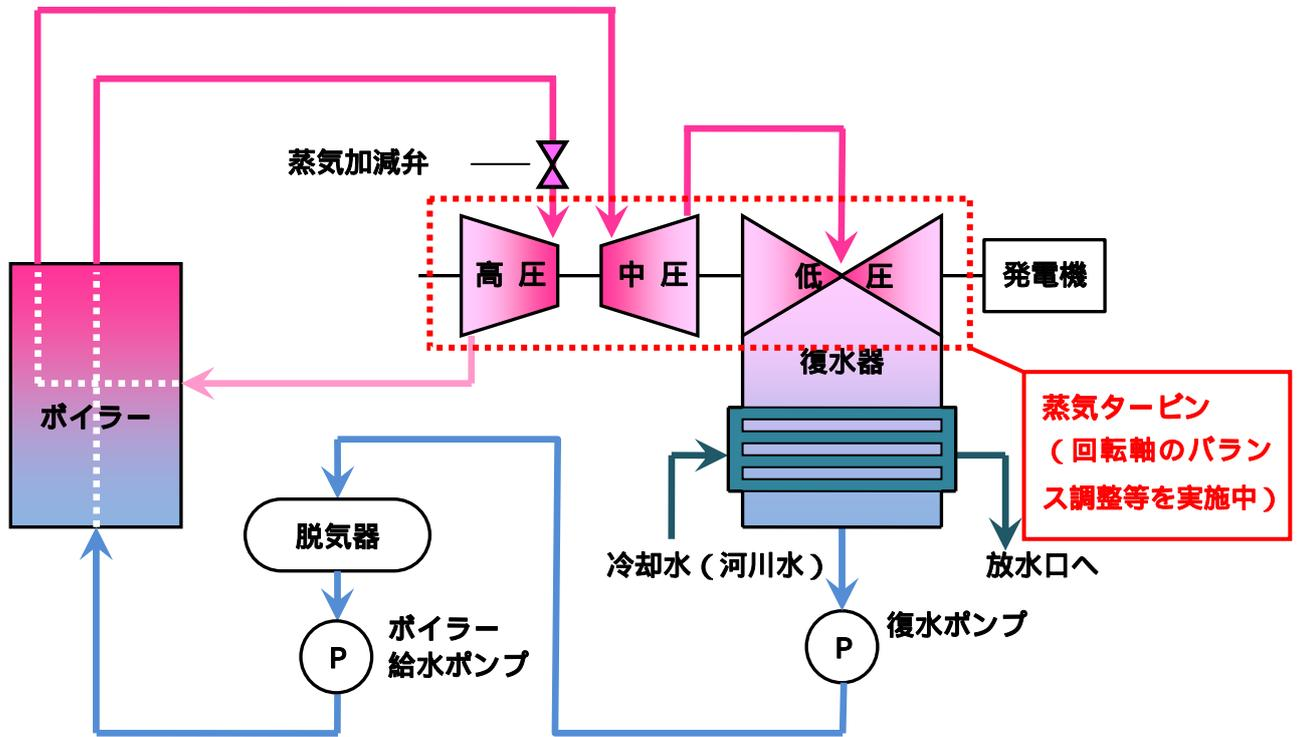
蒸気加減弁：蒸気タービンに入る蒸気の流量を調整し、蒸気タービンの回転数および発電機出力を制御するための弁
