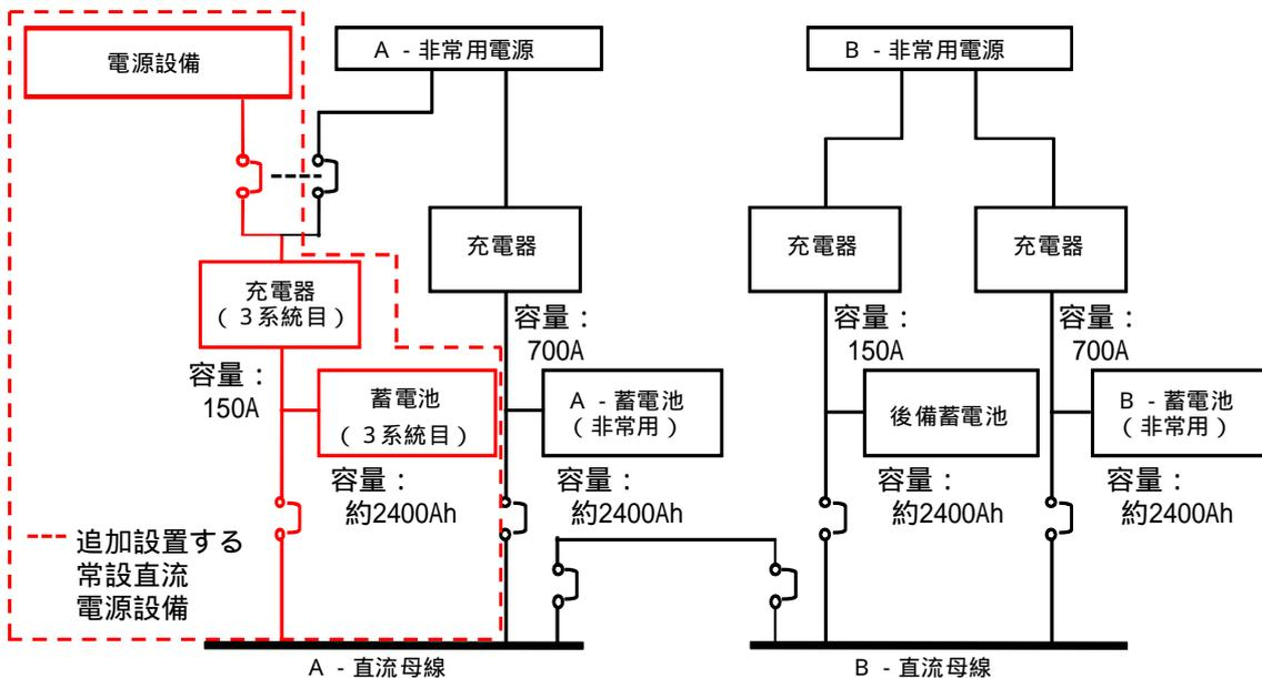
常設直流電源設備の概念図
