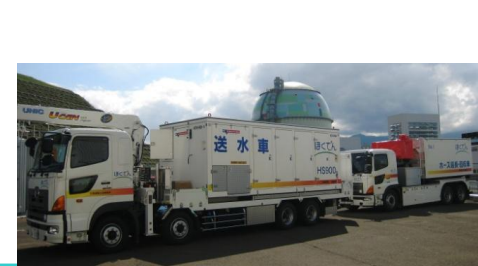
代替海水取水ポンプ
