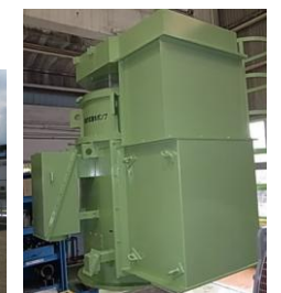
海水ポンプ電動機予備機
