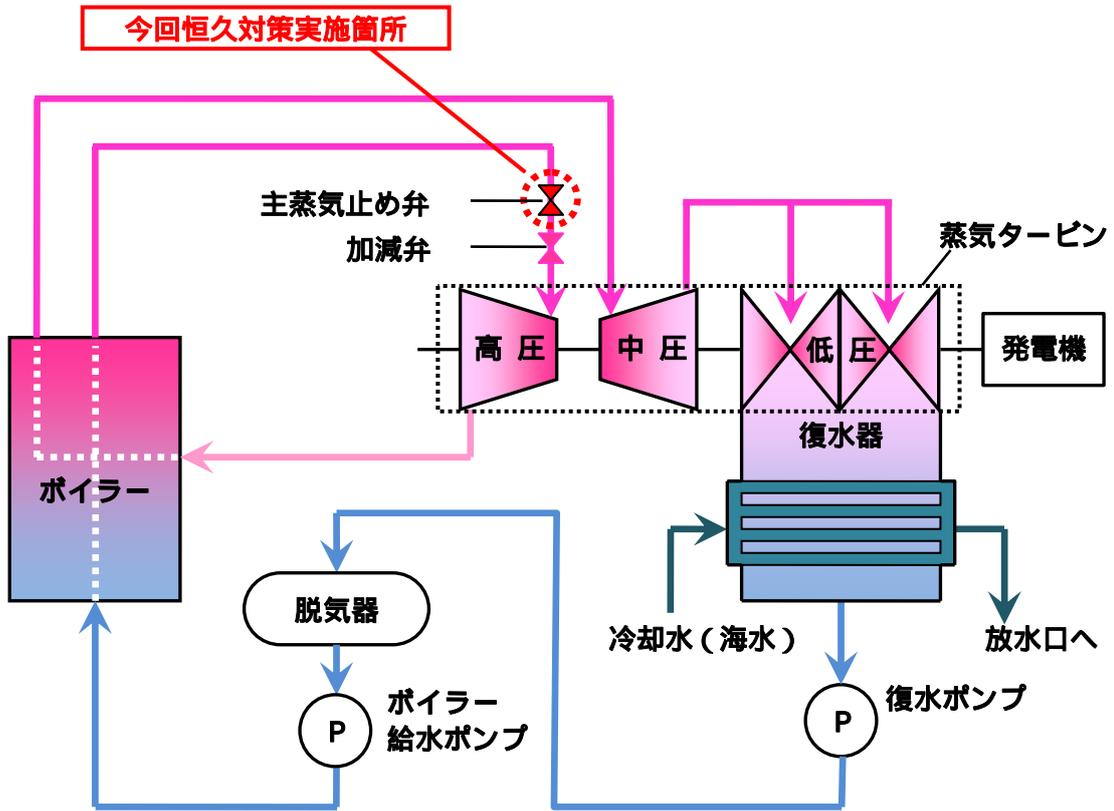
主蒸気止め弁：タービンに入る蒸気を遮断するための弁
