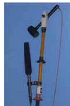
開閉器をハンマーで打撃し、打音を測定
