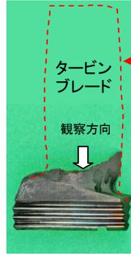
タービンブレードは、程度は異なるが全数(45枚)損傷。うち根元付近から損傷したものは11枚。
