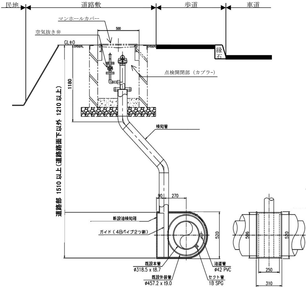
※ 上記構造図は鋼管外装管部分を示しており、この他、FRV外装管、さや管<sup>(\*)</sup>、地上配管に設置する検知口がある。
