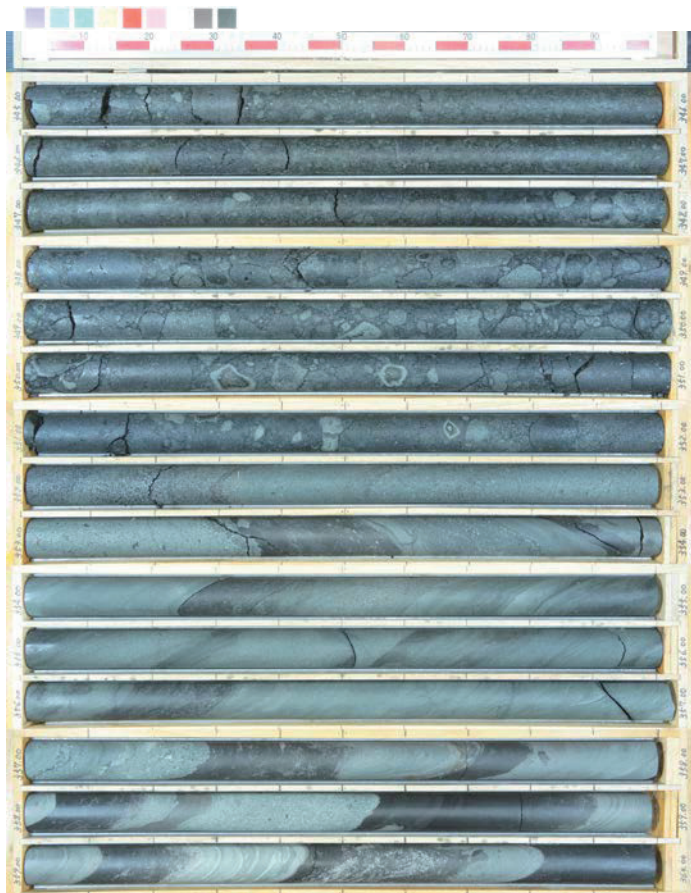
コア写真 (R1敷地-8: 深度345~360m)
