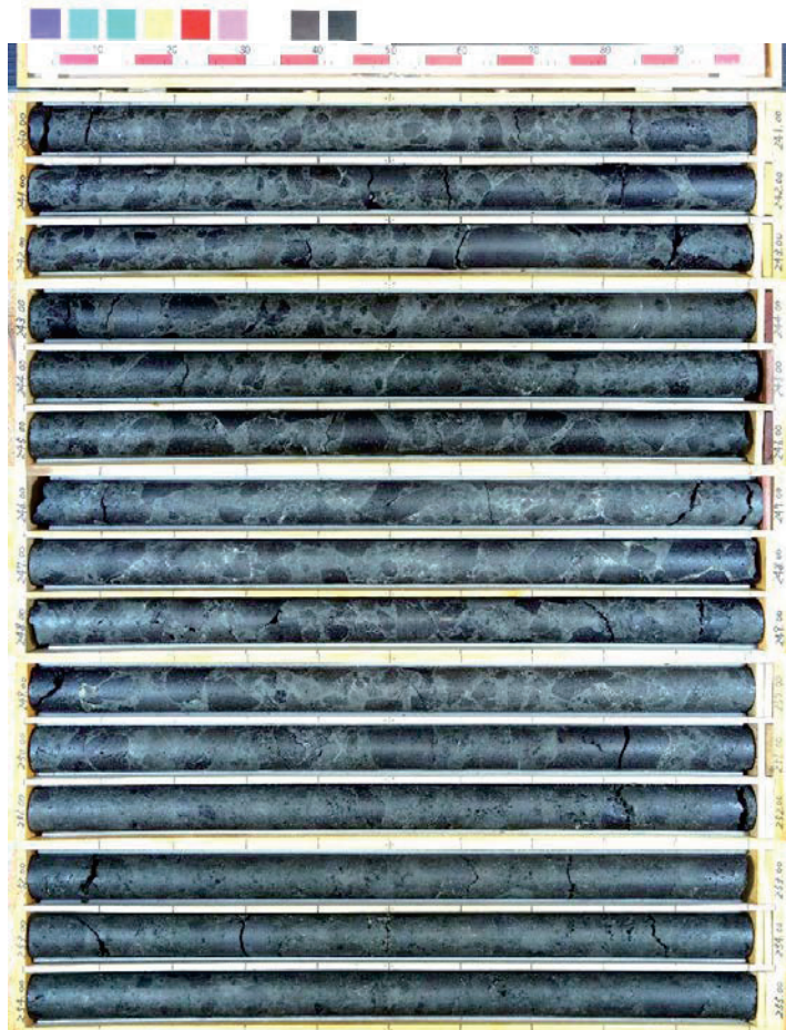
コア写真 (R1敷地-8: 深度240~255m)
