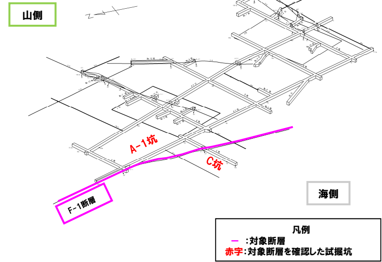
試掘坑におけるF-1断層の確認位置
