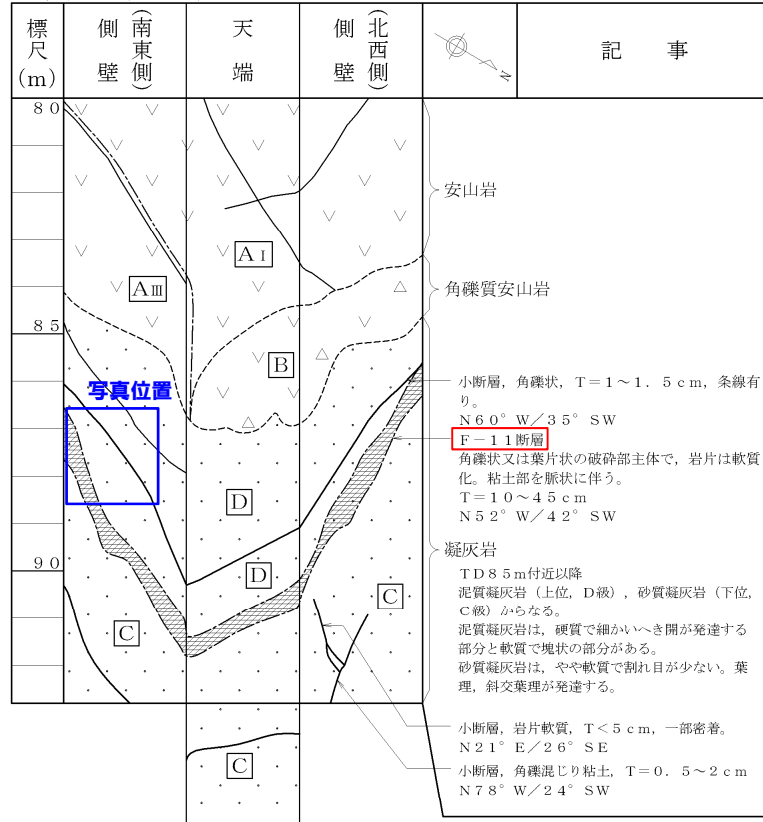
試掘坑展開図(B坑)
