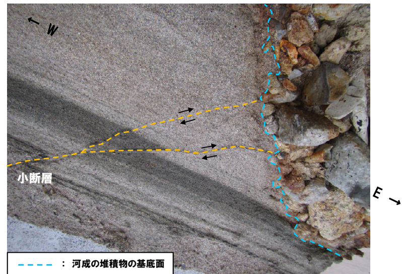
はぎとり転写試料 写真(斜め上方より撮影, 左右反転)(解釈線あり)
