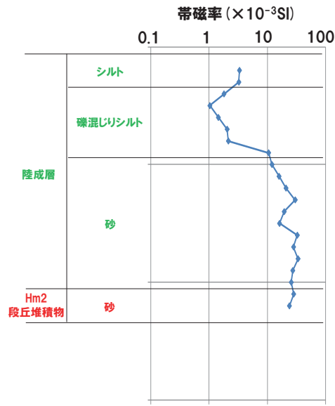
測線:A-1-c 帯磁率測定結果
