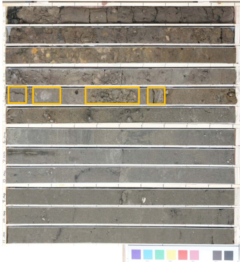
ボーリングコア写真(発足) 孔口標高 3.39m 抽出範囲
