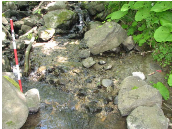
写真14 河床に分布するよく締った礫層。
