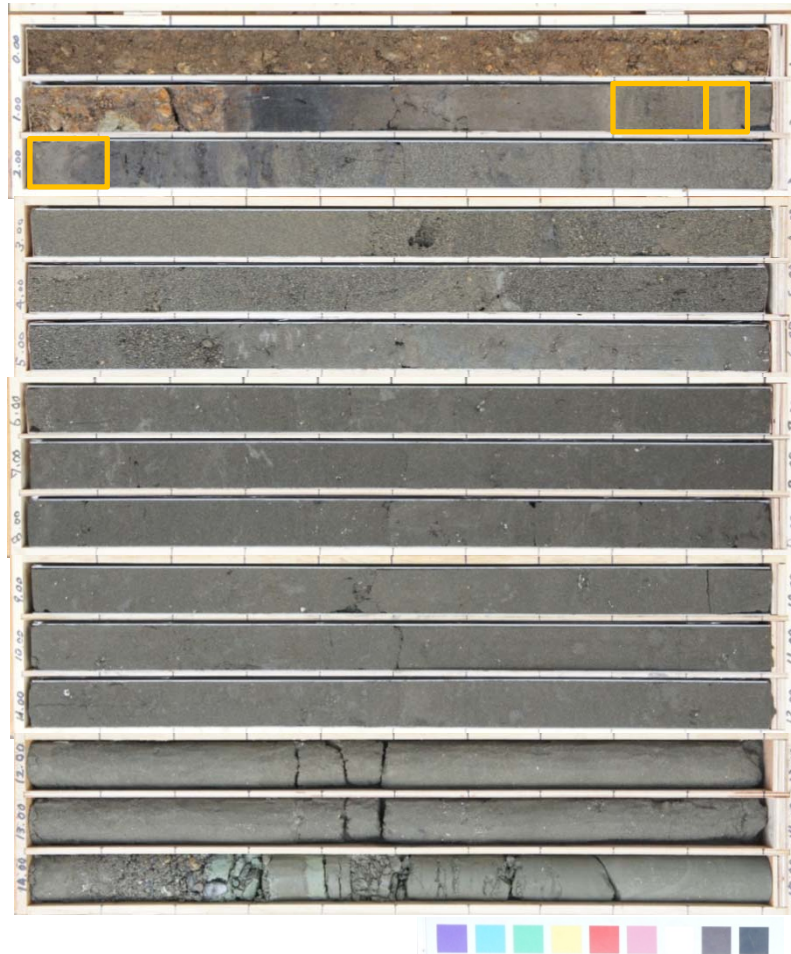
ボーリングコア写真(堀株川右岸) 孔口標高 1.74m 抽出範囲
