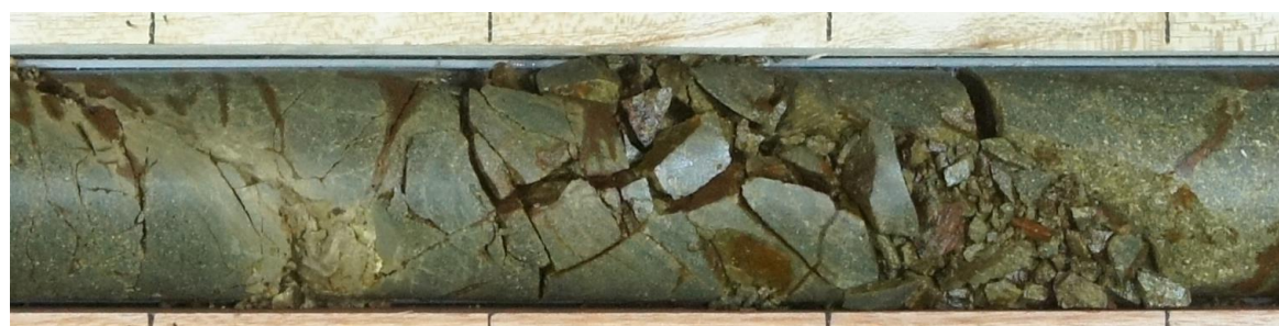
劣化部拡大写真(深度18.47～18.83m)
