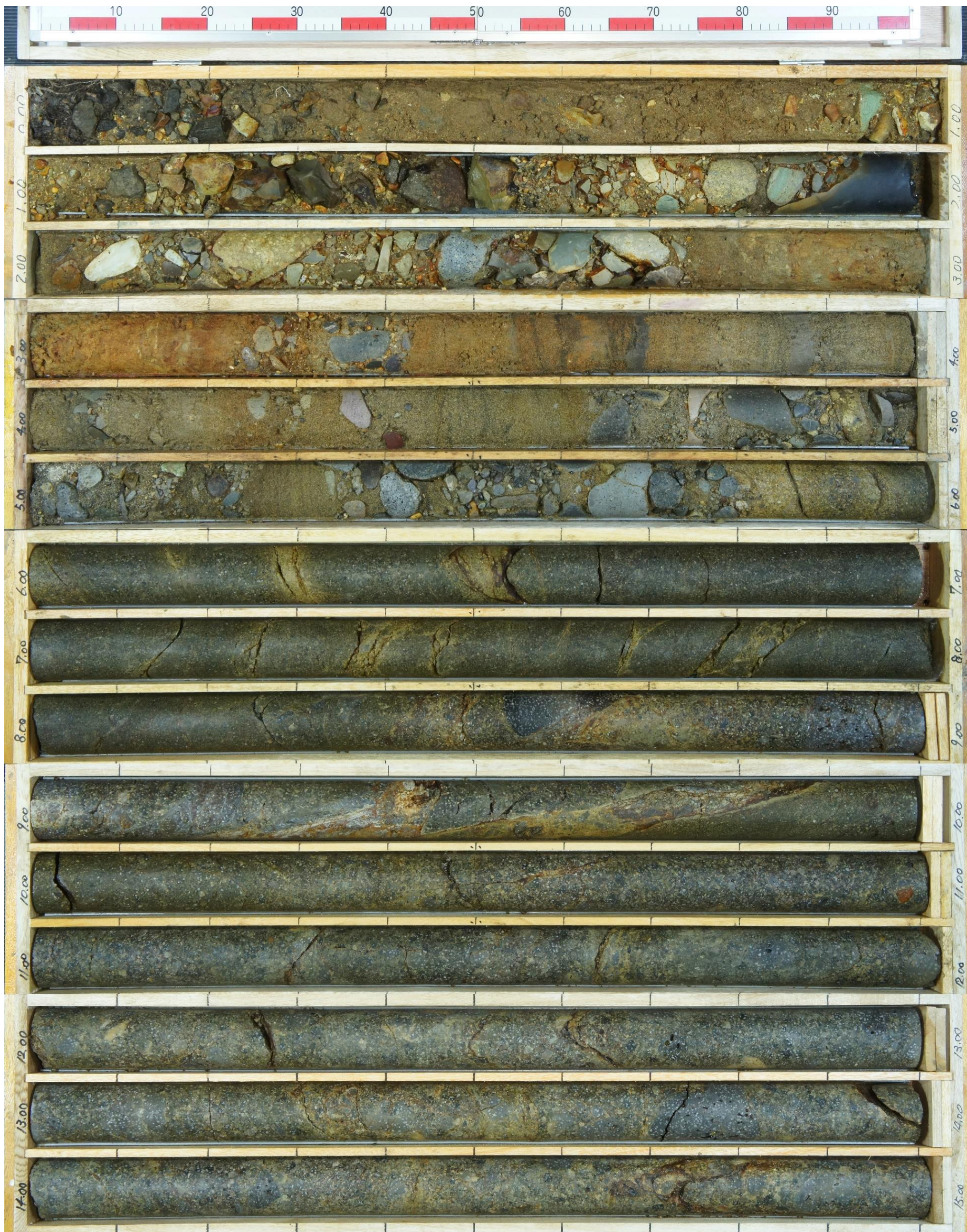
コア写真(確認-3ボーリング:深度0~15m)
