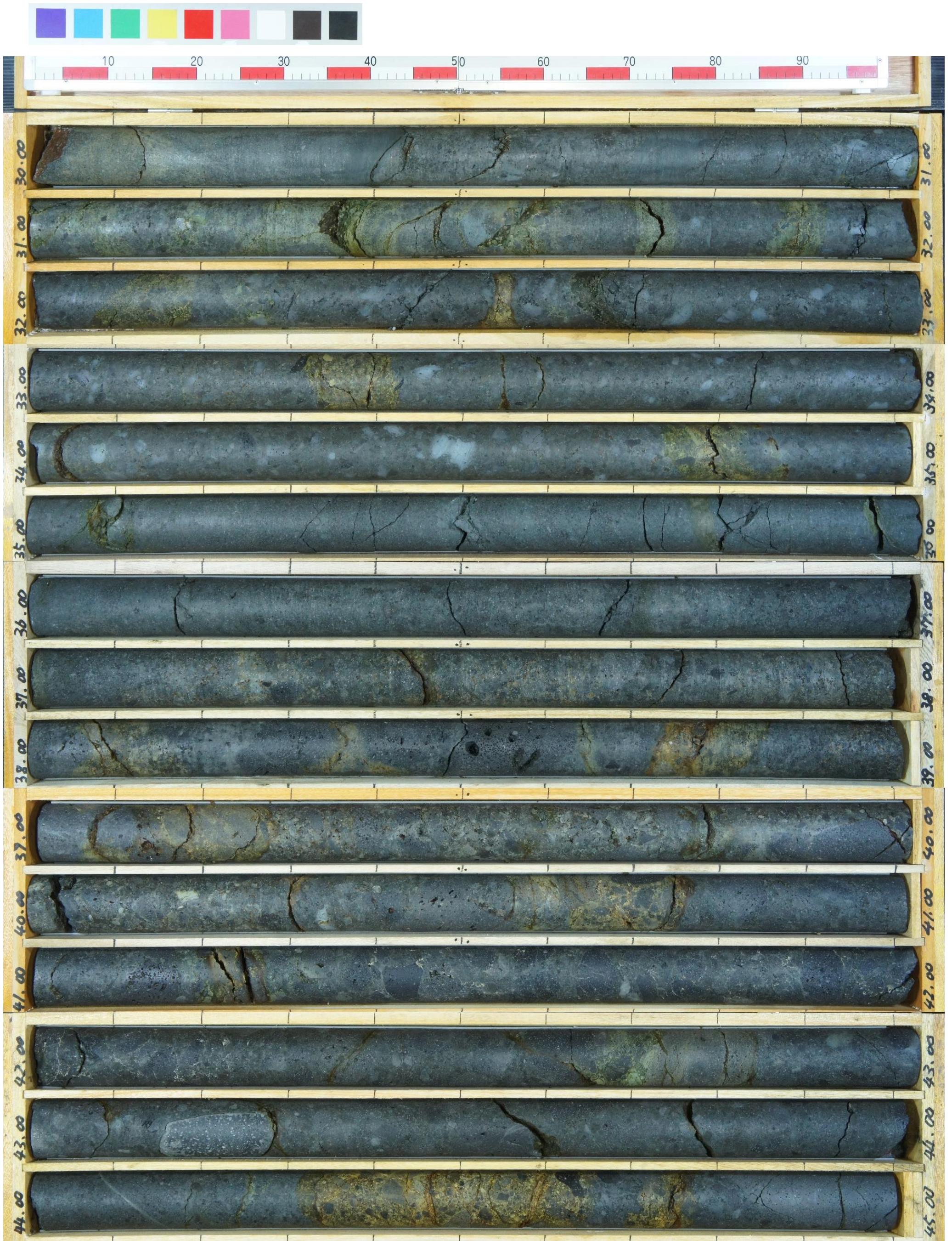
コア写真(確認-1ボーリング:深度30~45m)
