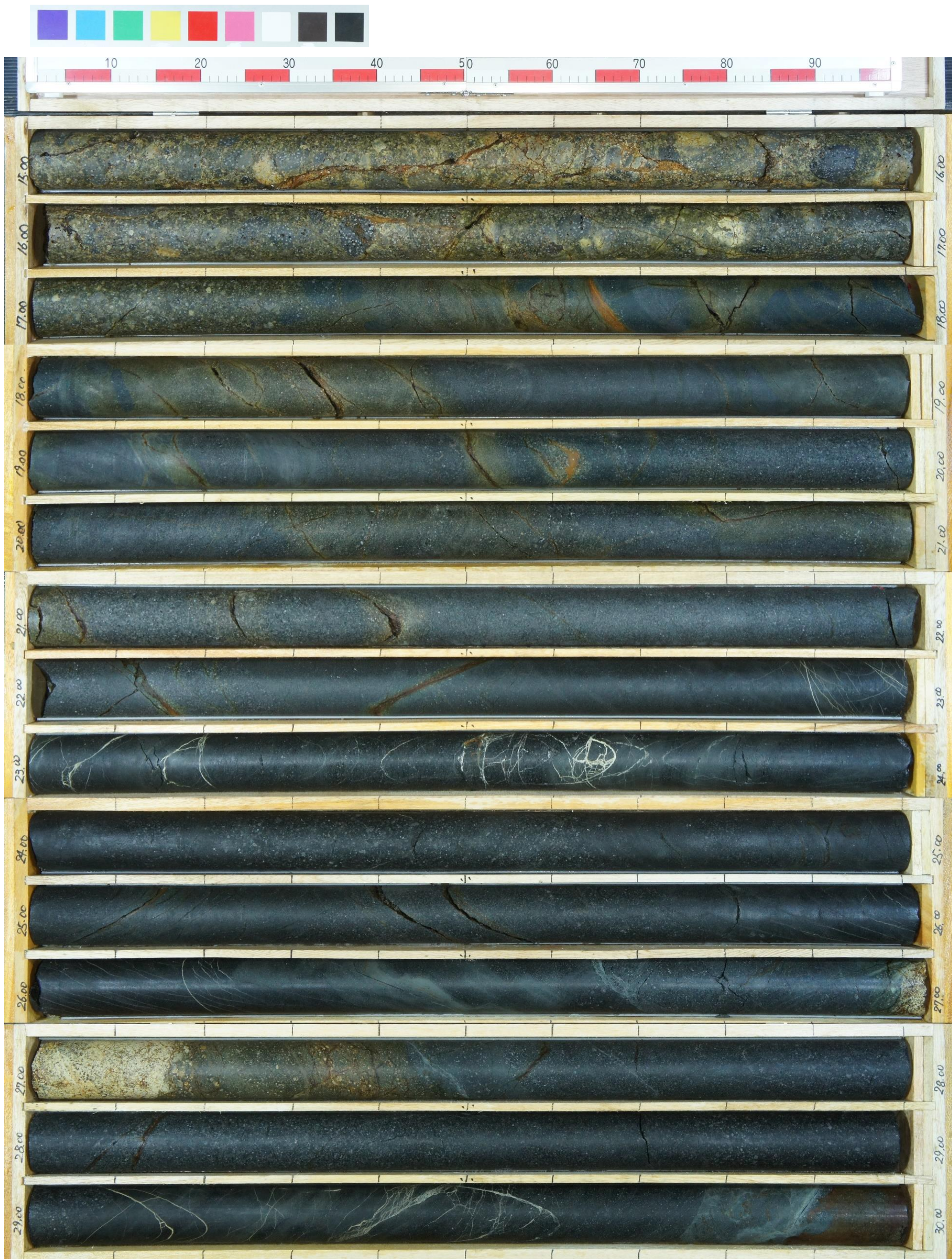
コア写真(確認-3ボーリング:深度15~30m)
