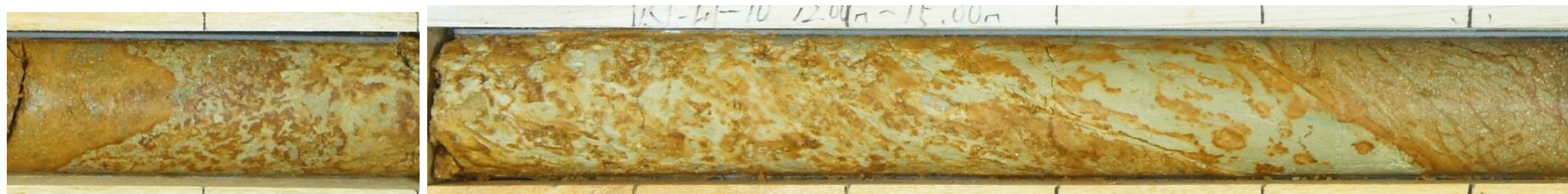
劣化部拡大写真(深度11.80～12.54m)
