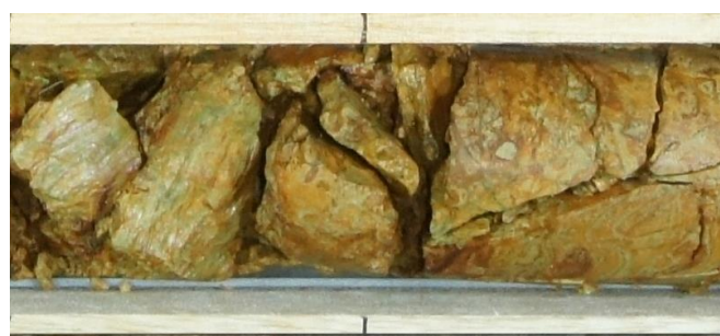
劣化部拡大写真(深度11.60～11.80m)
