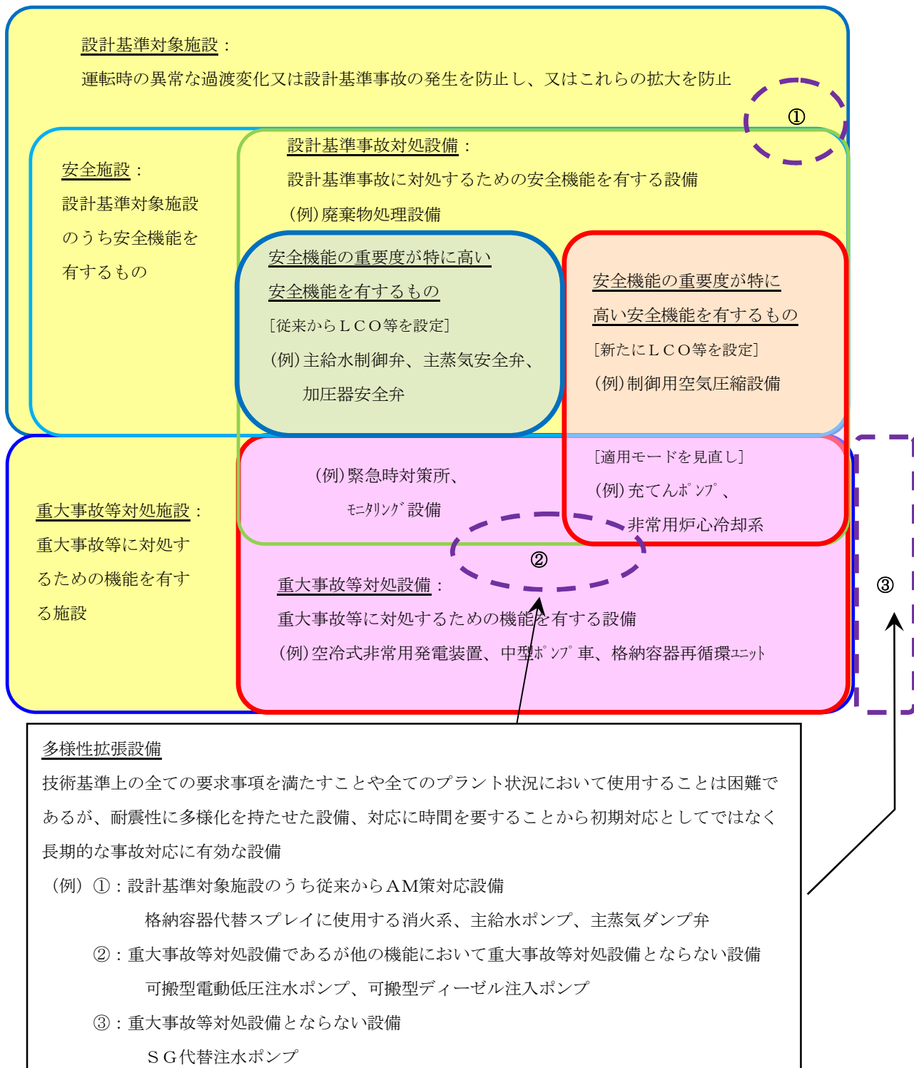
第 4.1 図 発電用原子炉施設の区分
